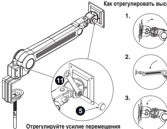
Отрегулируйте усилие перемещения движущегося рычага гаечным ключом.
